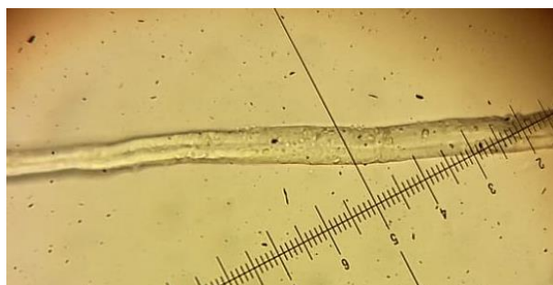
Figure 144 : Coupe franche de la fibre de polyester observé sous microscope, grossissement x40
