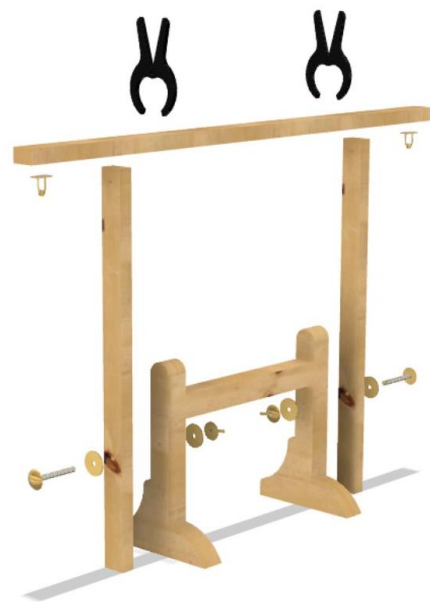
Figure 61 : Vue éclatée des différents éléments composants la machine à pelage
