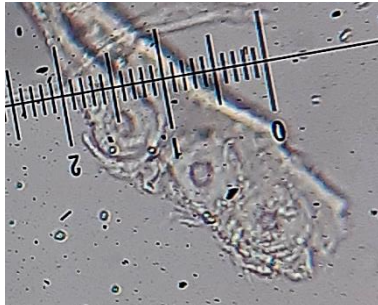
Figure 146 : Ponctuations aréolées observées sous microscope, grossissement x40
