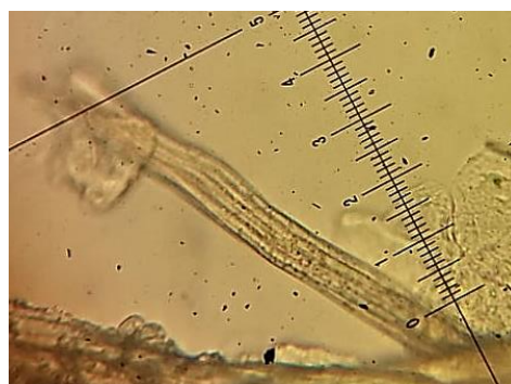
Figure 145 : Fibre de viscose à la forme crénelée observée sous microscope, grossissement x 40
