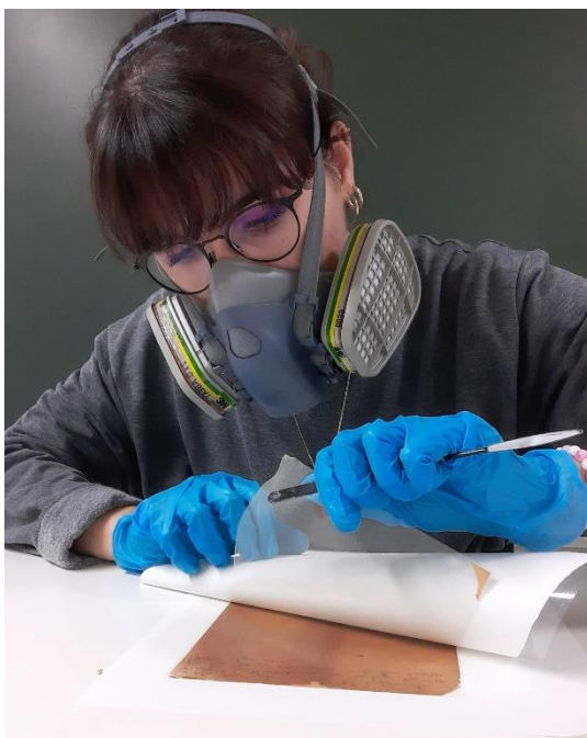
Figure 115 : Retrait du matériau thermocollant après le temps de pose du matériau Evolon® imprégné d'acétone
