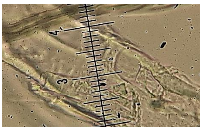
Figure 151 : Ponctuations de type pinoïde observées sous microscope, grossissement x40
