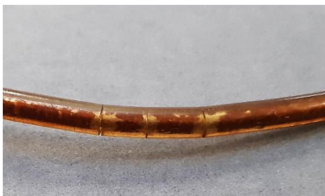
Figure 105 : Trois fêlures sur la branche de lunettes
