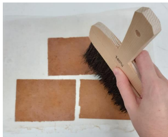
Figure 119 : Utilisation du pinceau Nazebake à travers un intissé
