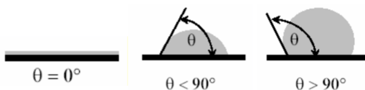
Schéma 10 : Angle de contact sur la surface d'un papier, afin de déterminer sa porosité
