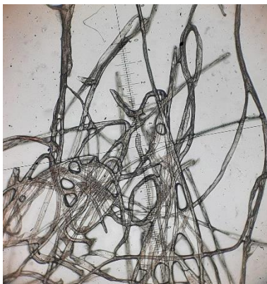
Figure 149 : Fibres de coton vrillées observées sous microscope, grossissement x10
